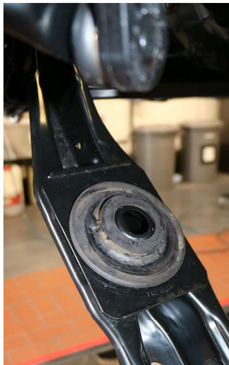
Abb. 2: Das Federgummi ersetzt das Federschloss
