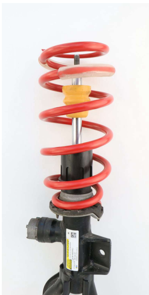
Abb. 2: Feder und Anschlagpuffer montieren
