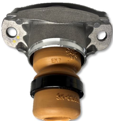
Abb. 7: Anschlagpuffer montiert im Stützlager Fig. 7: bump rubber mounted in support bearing
