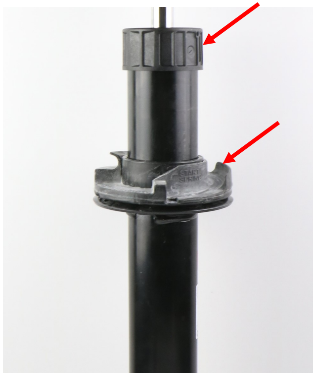
Abb. 6: Abdeckkappe und Federunterlage demont.
