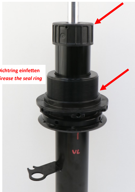
Abb. 2: Höhenverstellung und Abdeckkappe mont.
