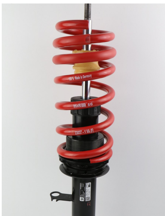
Abb. 3: Anschlagpuffer und Feder montieren
