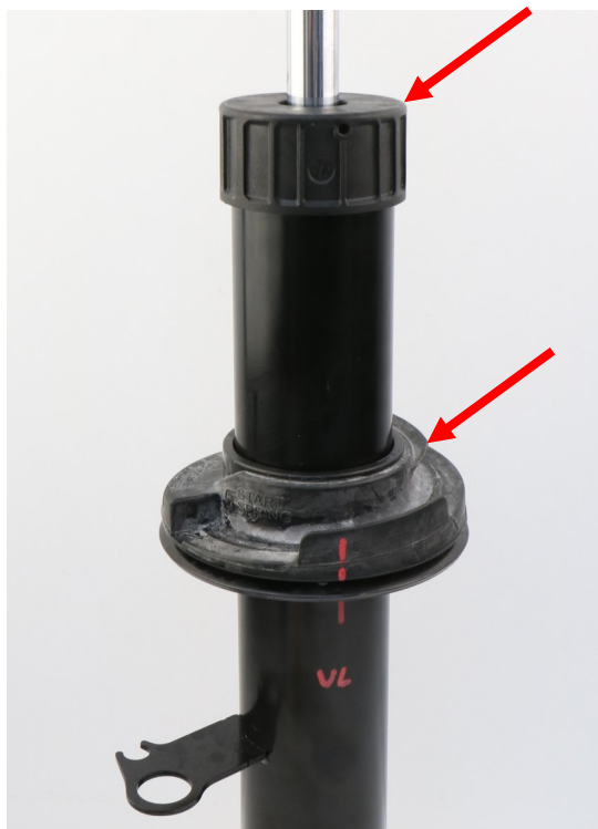
Abb. 1: Abdeckkappe und Federunterlage demont.
