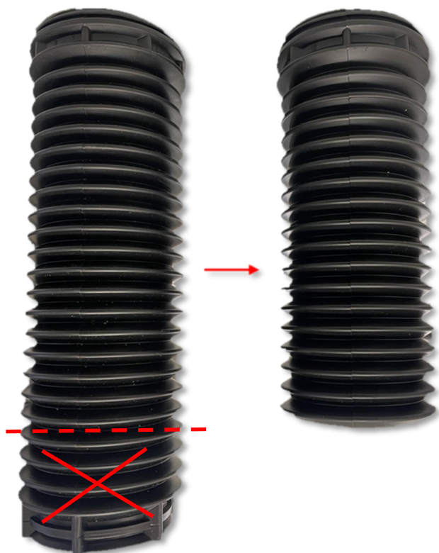
Abb. 1: VA Schutzrohr kürzen Fig. 1: FA shorten dust cover
