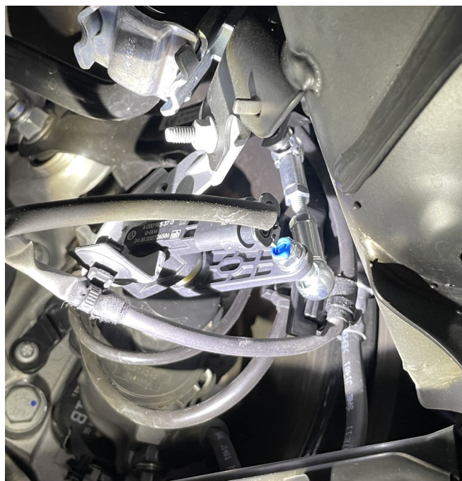
Abb. 1: Austausch der Niveauregelstangen HA (Abb. ähnlich) Fig. 1: Exchange of the level control rods RA (Fig. may vary)
