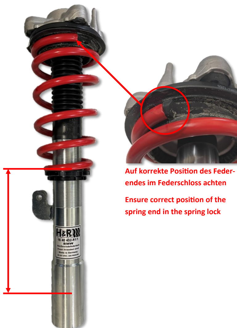
Abb. 2: Einstellmaß VA & Position Federende
