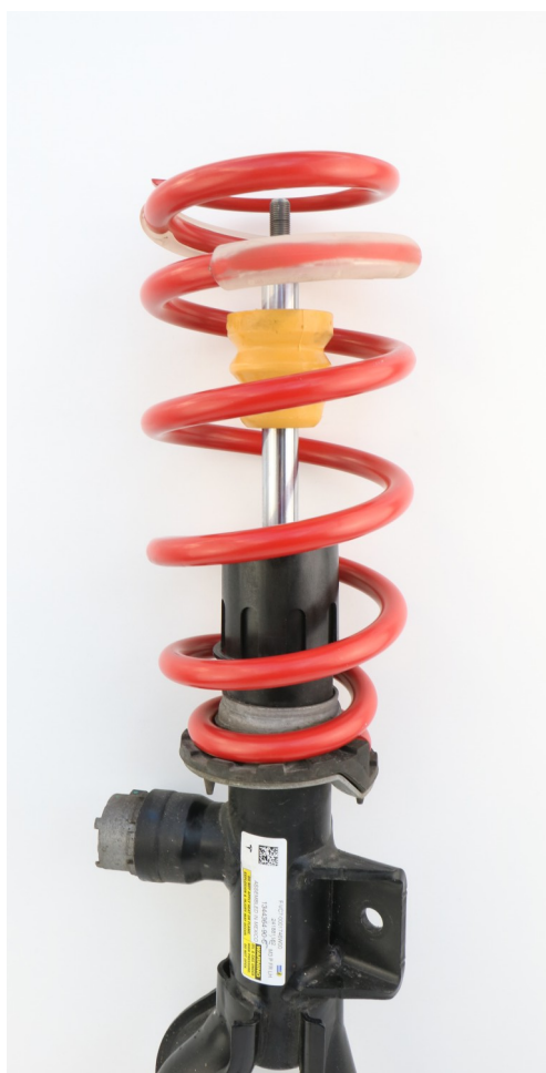
Abb. 2: Feder und Anschlagpuffer montieren
