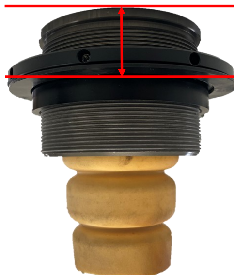
Abb. 5: HA Einstellmaß Fig. 5: RA adjustment dimension
