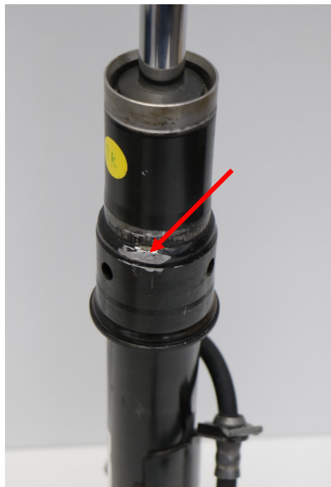
Abb. 2: Fertigungstoleranzen entfernen Fig. 2: Remove manufacturing tolerances
