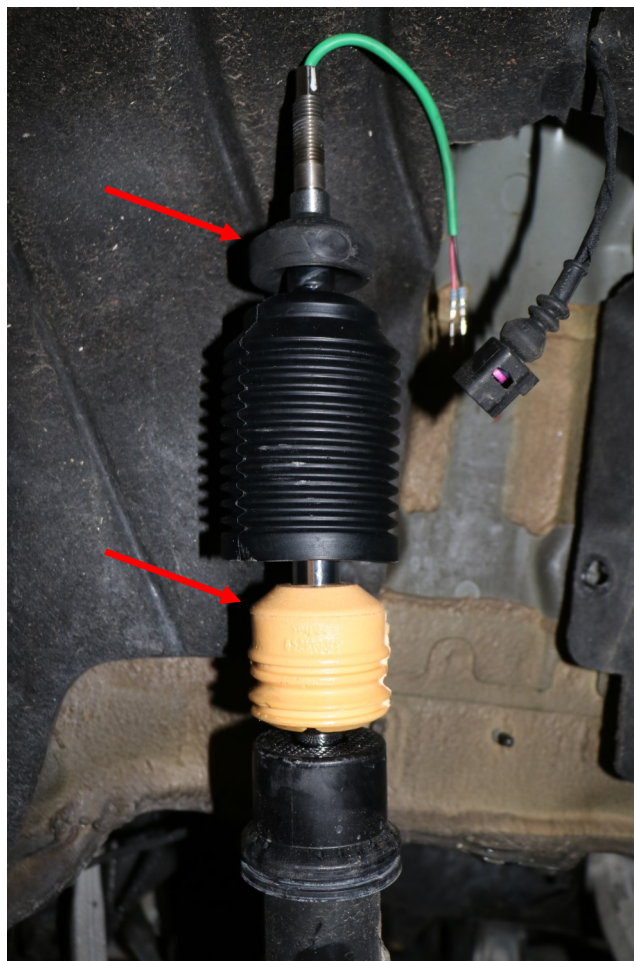
Abb. 8: Anschlagpuffer und Schutzrohr mont.
