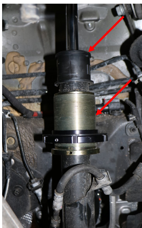
Abb. 4: Höhenverstellung und Abdeckkappe mont. Fig. 4: Mount the height adjuster and cap
