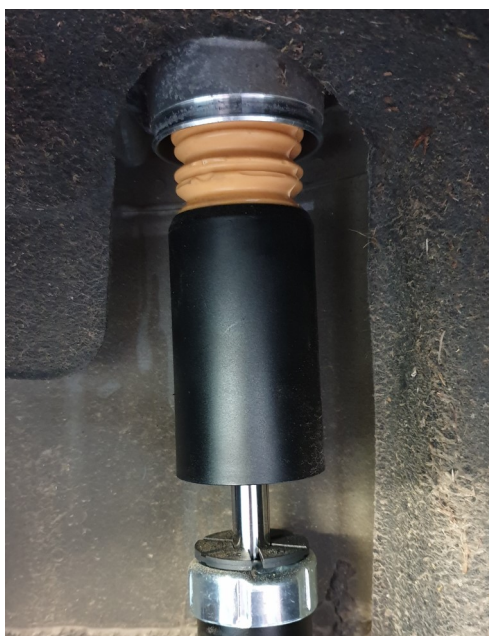
Abb. 6: Stützlager auf Dämpfer montieren (Abb. ähnlich)
