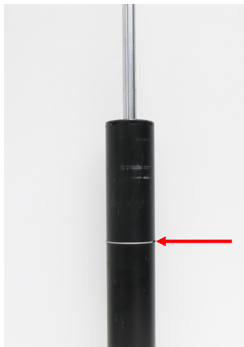
Abb. 2: Alle Teile bis auf den Sprengring entfernen Fig. 2: Remove all parts except the snap ring
