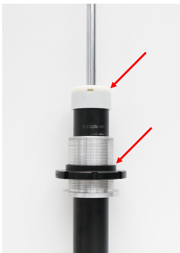
Abb. 3: Höhenverstellung und Abdeckkappe mont. Fig. 3: Mount the height adjuster and cap
