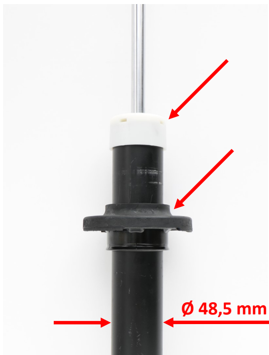
Abb. 1: Abdeckkappe und Federteller demontieren Fig. 1: Dismantle cap and spring plate
