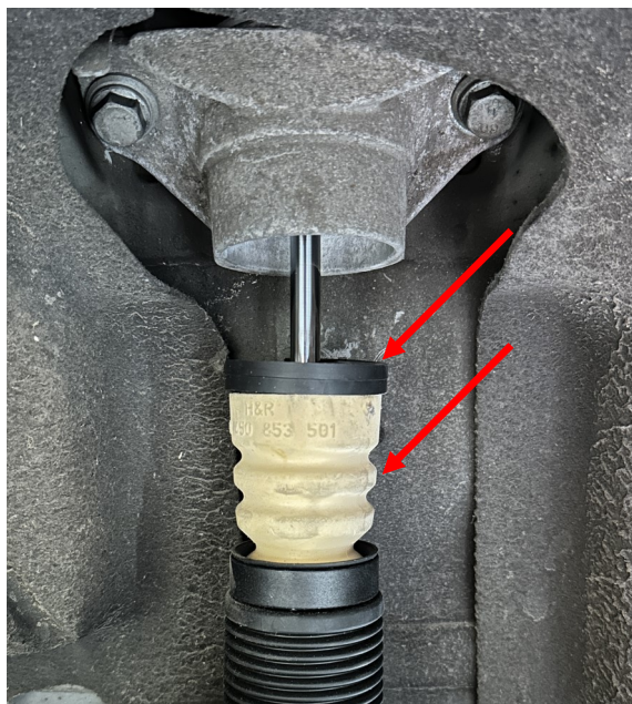
Abb. 6: Anschlagpuffer und Schutzrohr montieren (Abbildung ähnlich)
