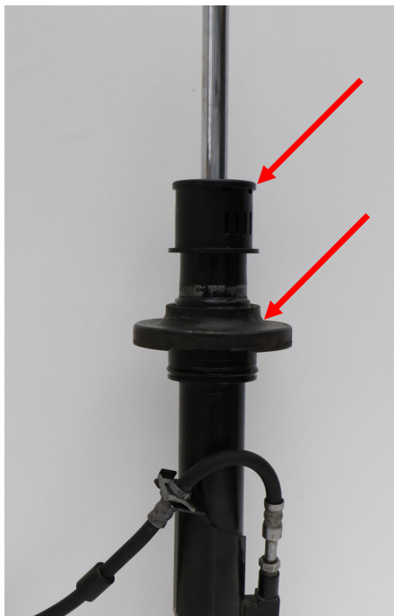
Abb. 1: Abdeckkappe und Federteller demontieren Fig. 1: Dismantle cap and spring plate
