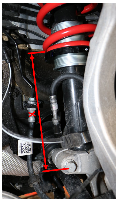
Abb. 4: Einstellmaß X VA (Abbildung ähnlich) Fig. 4: Adjustment dimension X FA (Fig. may vary)
