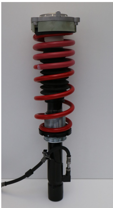
Abb. 5: Feder-Dämpfer-Einheit komplett (Abbildung ähnlich)
