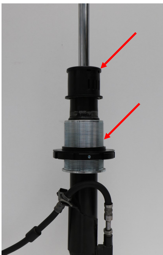
Abb. 3: Höhenverstellung und Abdeckkappe mont. Fig. 3: Mount the height adjuster and cap
