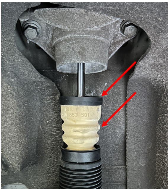
Abb. 6: Anschlagpuffer und Schutzrohr montieren (Abbildung ähnlich)
