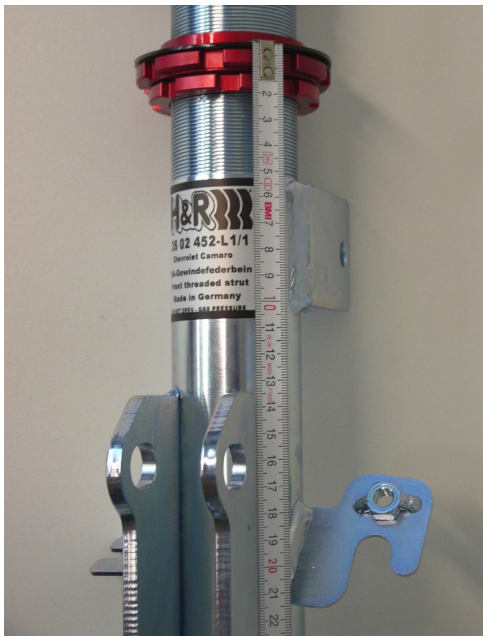
Bild 1/Pic. 1: Einstellmaß VA/FA spring plate adjustment dimension
