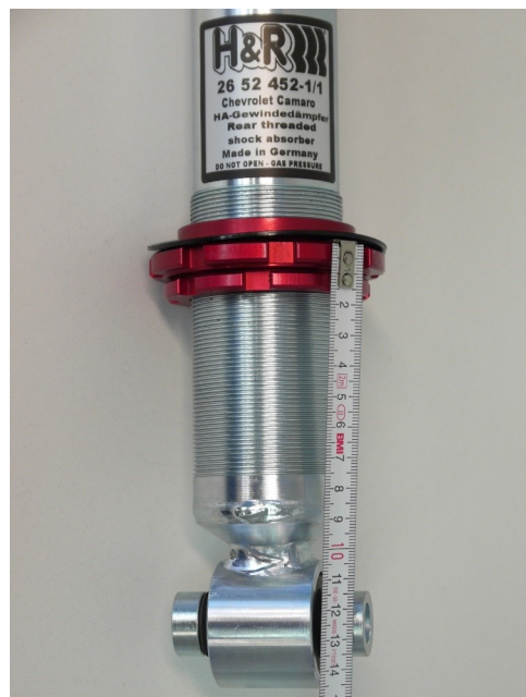
Bild 2/Pic. 2: Einstellmaß HA/RA spring plate adjustment dimension
