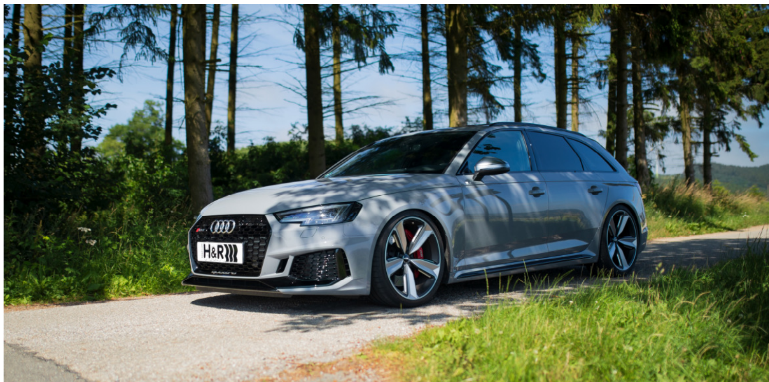
Prüffahrzeug Audi RS4, Typ B9, mit H&R Gewindefahrwerk 28694-2 bei max. geprüfter Tieferlegung
