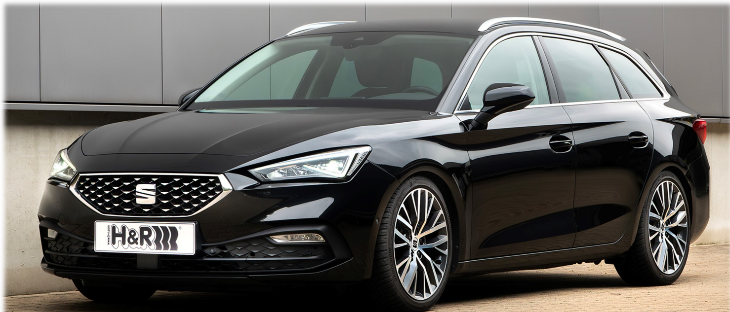
Prüffahrzeug Seat Leon ST mit H&R-Gewindefahrwerk 28638-17 bei max. geprüfter Tieferlegung
