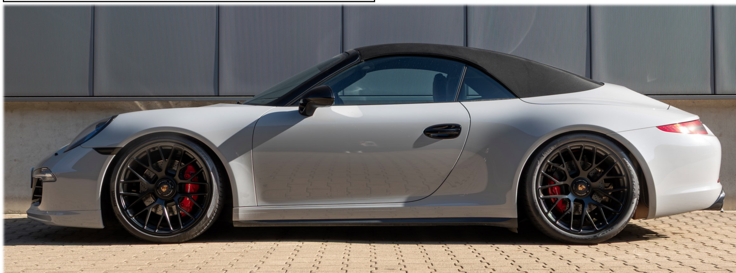
Prüffahrzeug Porsche 991 Carrera Cabrio mit H&R-Gewindefahrwerk 28552-1 bei max. geprüfter Tieferlegung
