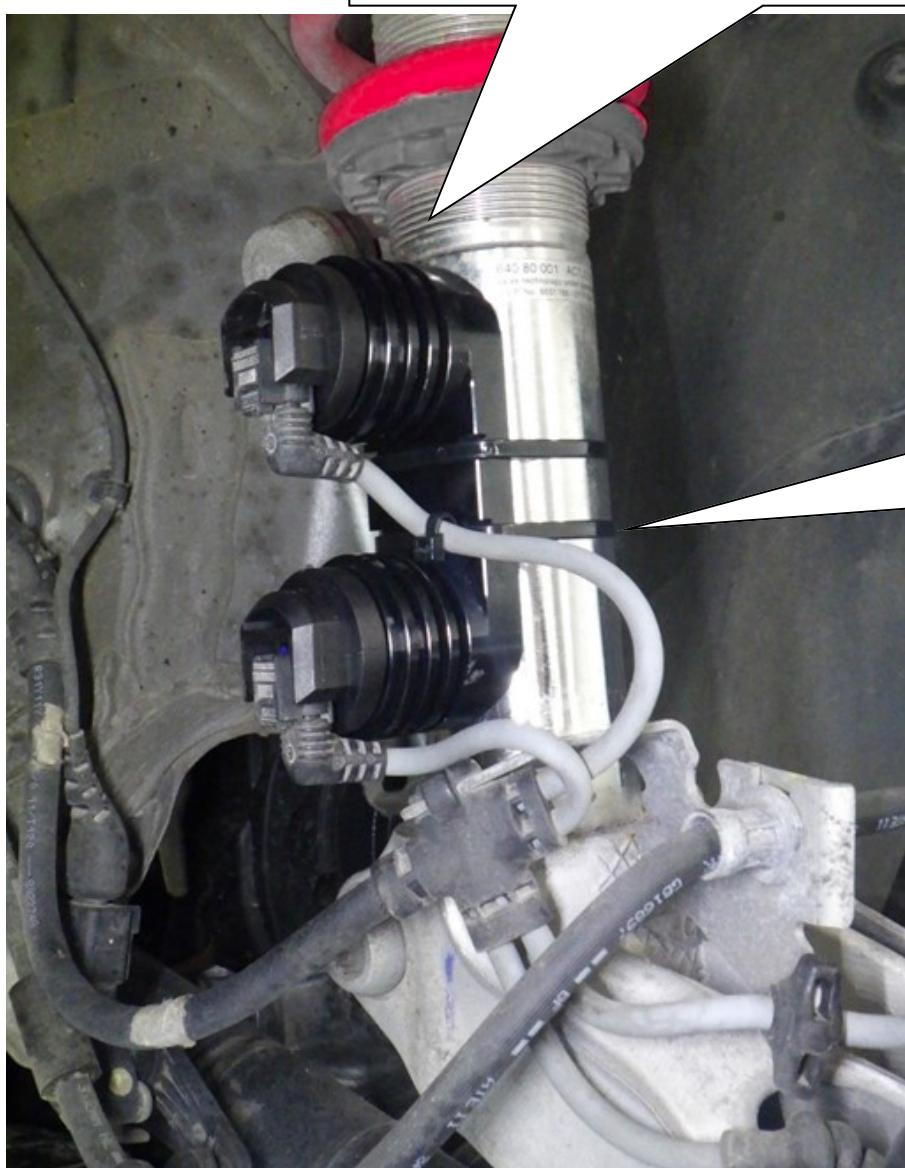
Originale Leitungen in die Stillegung einstecken. Auf die korrekte Verriegelung des Steckers achten! Leitung ebenfalls mit einem Kabelbinder fixieren.
