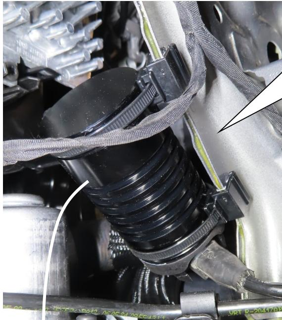
Originale Dämpfersteuerungsleitung in die mitgelieferte Stilllegung einstecken.
