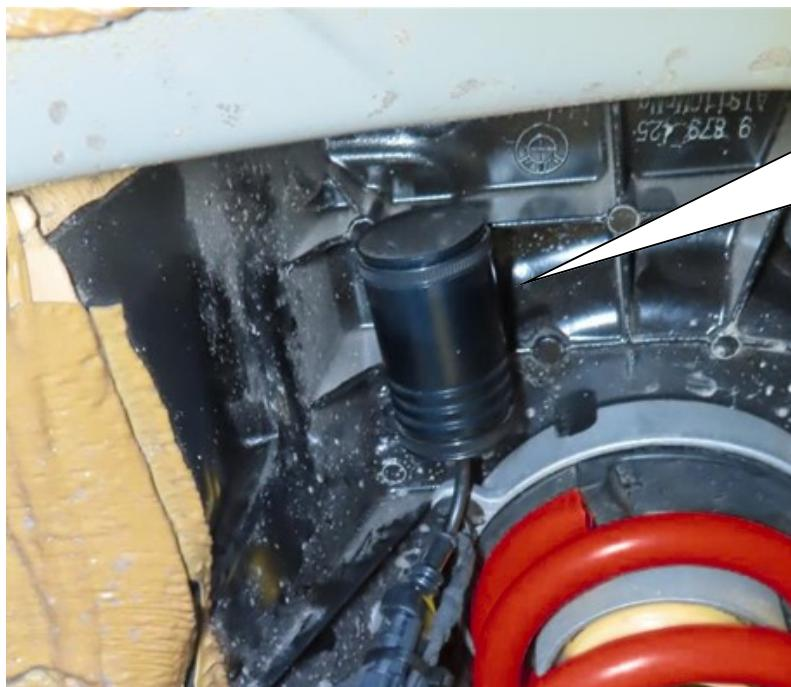
HA Stilllegung einstecken und mit Edge Clips an der Kante am Fahrzeugdome befestigen. Auf die korrekte Verriegelung des Steckers achten! Leitung und Steckverbindung mit einem Kabelbinder fixieren.
