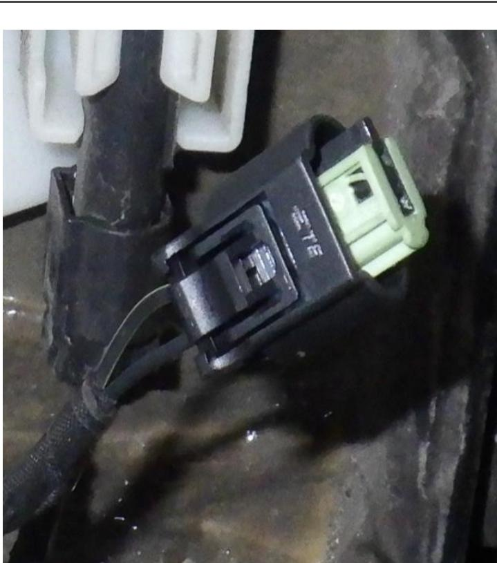
Alternativ kann auch anstelle der mitgelieferten Buchse die serienmäßige OEM Buchse verwendet werden. Hierzu muss jedoch die Kodierung an der Buchse mit einem Messer oder einer kleinen Zange entfernt werden.
