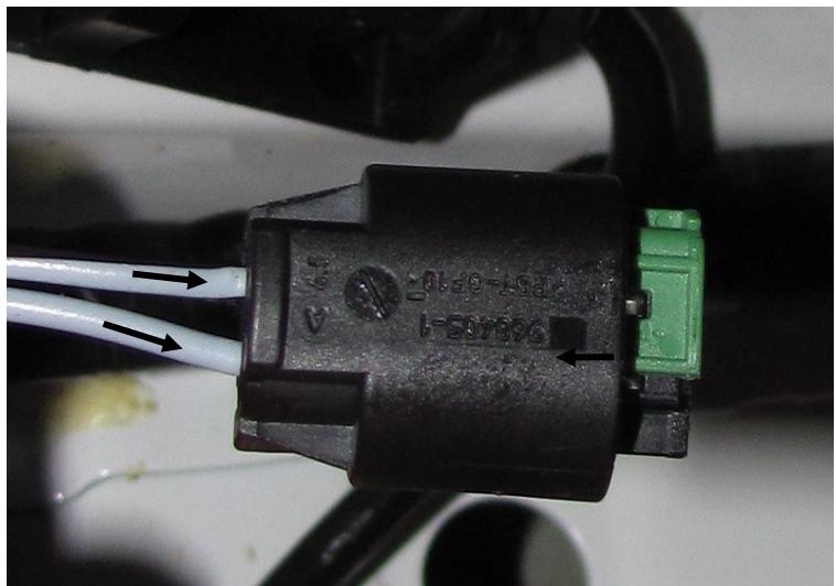
Alternativ kann auch anstelle der mitgelieferten Buchse die serienmäßige OEM Buchse verwendet werden. Hierzu muss jedoch die Kodierung an der Buchse mit einem Messer oder einer kleinen Zange entfernt werden.
