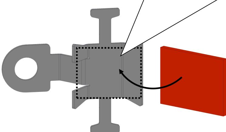
Mitgelieferte Stillegung mittig auf den Halter ankleben und zusätzlich mit zwei Kabelbindern befestigen.
