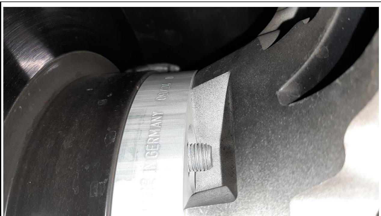
Überstand der originalen Stehbolzen nach Verbau der Spurverbreiterungen und
