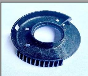
Eibach liefert für den ID.3 hintere Schraubenfedern mit einer Federbeilage, die in einer Kunststoffschale am unteren Ende der Original-Schraubenfeder sitzt. Diese Kunststoffschale lässt sich einfach vom unteren Ende der defekten Schraubenfeder abziehen und sollte nach Reinigung und Überprüfung auf die mit der Eibach-Schraubenfeder mitgelieferte Federbeilage montiert werden.
