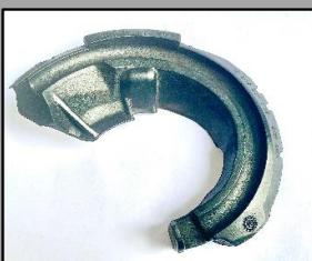
Eibach empfiehlt, die untere Federbeilage (OE-Nr. 5Q0 412 545 D), der vorderen Feder immer dann zu erneuern, unten links und rechts, wenn neue vordere Schraubenfedern eingebaut werden.
