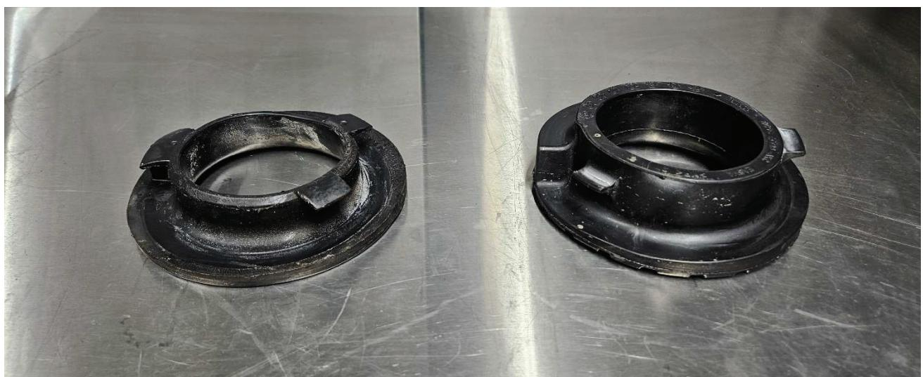
Die Montage der Hinterachs-Tieferlegungsfedern erfolgt unter Verwendung der mitgelieferten Federauflagen gemäß Werkstatthandbuch!
