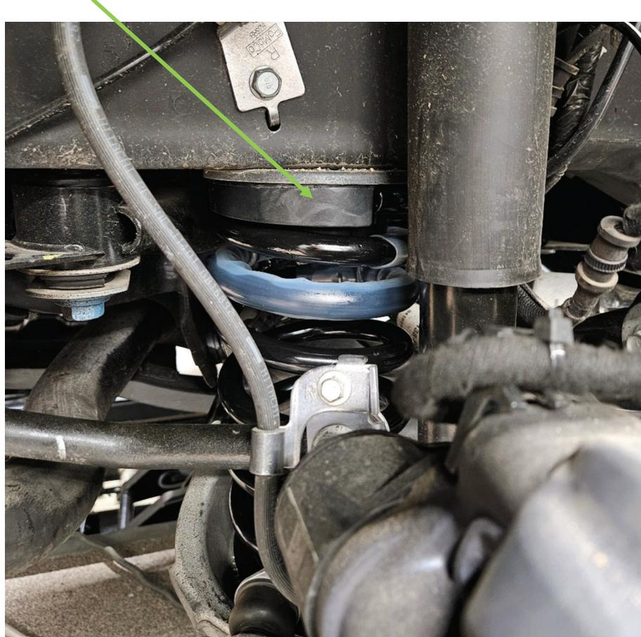
Bei aktivem Dämpfungssystem (MagneRide) sind die unterschiedlichen Steigungsverläufe der Federauflagen bzw. Winderichtungen der Federn zu beachten.
