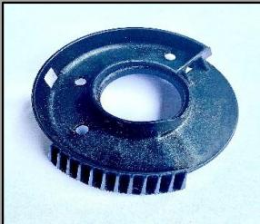
Eibach liefert für den ID.7 hintere Schraubenfedern mit einer Federbeilage, die in einer Kunststoffschale am unteren Ende der Original-Schraubenfeder sitzt. Diese Kunststoffschale lässt sich einfach vom unteren Ende der defekten Schraubenfeder abziehen und sollte nach Reinigung und Überprüfung auf die mit der Eibach-Schraubenfeder mitgelieferte Federbeilage montiert werden.
