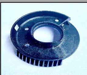
Eibach liefert für den ID.4 hintere Schraubenfedern mit einer Federbeilage, die in einer Kunststoffschale am unteren Ende der Original-Schraubenfeder sitzt. Diese Kunststoffschale lässt sich einfach vom unteren Ende der defekten Schraubenfeder abziehen und sollte nach Reinigung und Überprüfung auf die mit der Eibach-Schraubenfeder mitgelieferte Federbeilage montiert werden.
