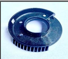
Eibach liefert für den Enyaq iV und Enyaq hintere Schraubenfedern mit einer Federbeilage, die in einer Kunststoffschale am unteren Ende der Original-Schraubenfeder sitzt. Diese Kunststoffschale lässt sich einfach vom unteren Ende der defekten Schraubenfeder abziehen und sollte nach Reinigung und Überprüfung auf die mit der Eibach-Schraubenfeder mitgelieferte Federbeilage montiert werden.
