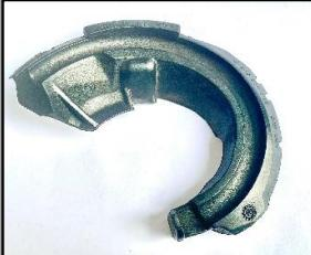
Eibach empfiehlt, die untere Federbeilage (OE-Nr. 500 412 545 D), der vorderen Feder immer dann zu erneuern, unten links und rechts, wenn neue vordere Schraubenfedern eingebaut werden.
