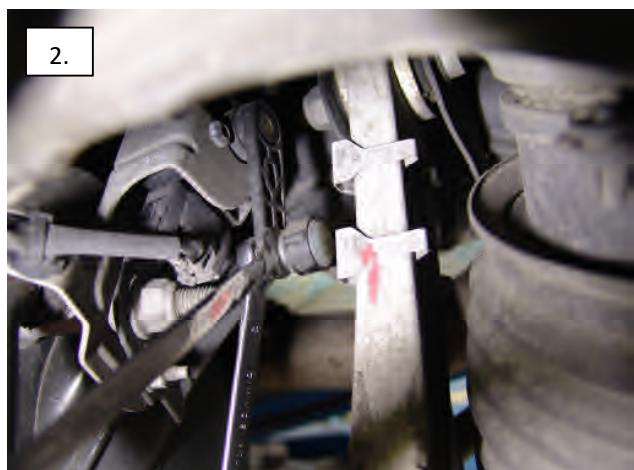
Serien Regelstangen der Höhenstandssensoren lösen und Regelstange entnehmen.
